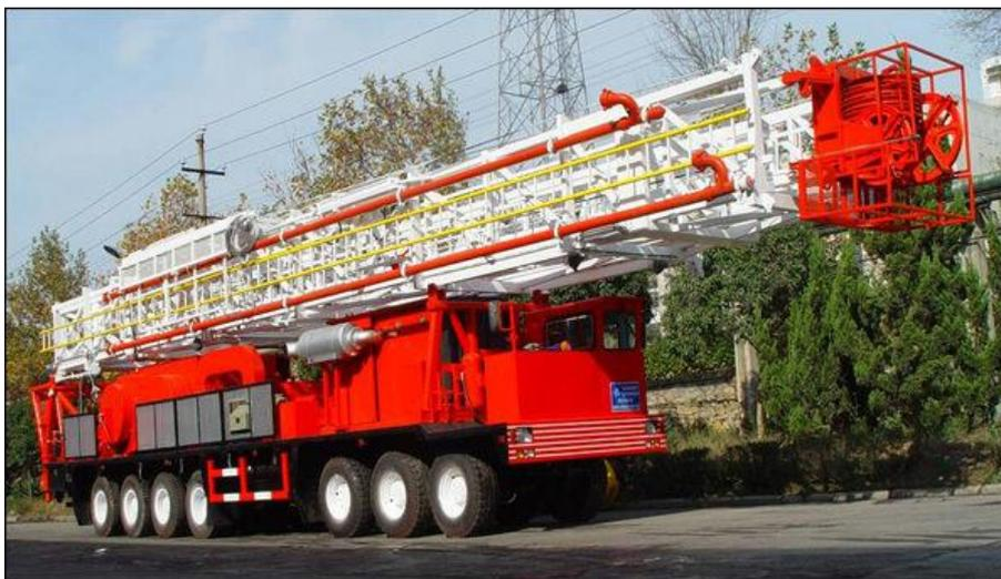
Передвижные нефтяные буровые установки незаменимы при разведывательных мероприятиях, а также изучения состава местности. С их помощью специалисты берут пробы на проведение различных исследований. Стационарные же модели необходимы для добычи материала.
